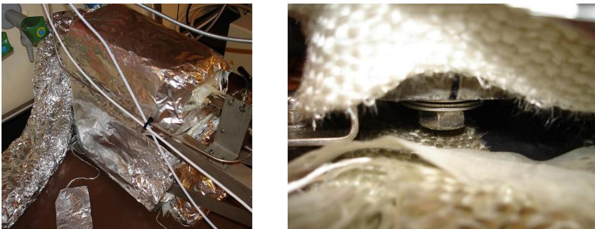
**Abbildung 5-7** Isolierung der Apparatur (li) und die Verschraubung mit Hohlscheiben (re.)
