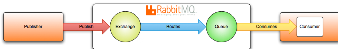
Abbildung 5.2: Zentrale Konzepte des AMQP-Netzwerkprotokolls.
