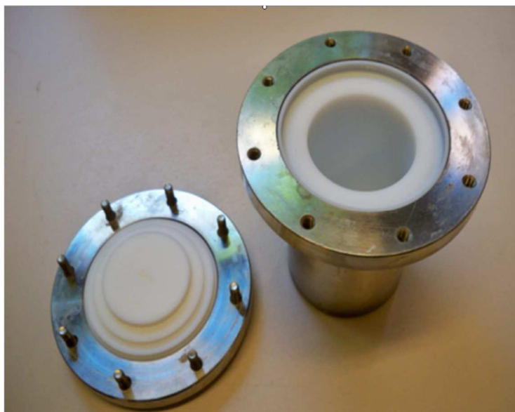
Abbildung 7.1: Edelstahlautoklav mit PTFE-Einsatz.
