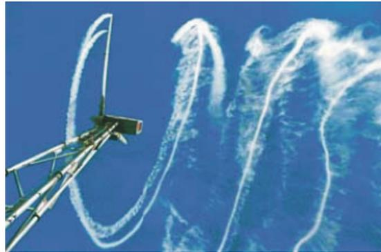
Abbildung 3.8: Nachlaufschweif einer Windenergieanlage in Dänemark. Dieser wurde durch Rauch sichtbar gemacht. Diese Windenergieanlage dreht sich im Gegensatz zu den meisten anderen Anlagen gegen den Uhrzeigersinn (Quelle: Risoe).
