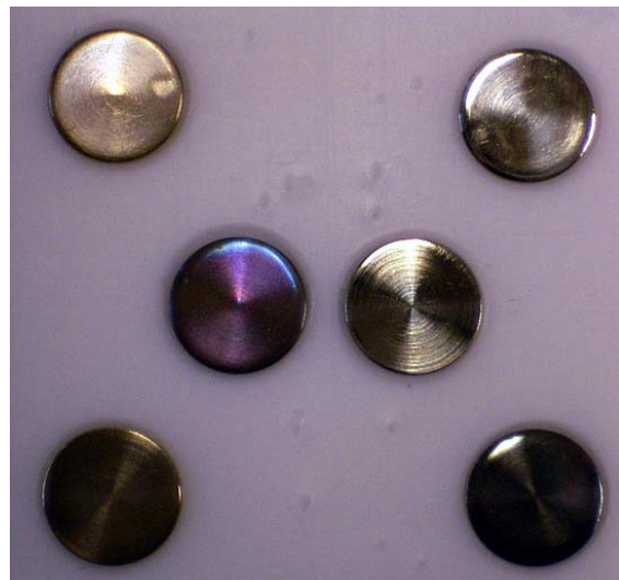
Abb. 9.28 Verfärbung der Edelstahlplättchen durch eine thermische Vorbehandlung von 350 °C auf diversen Edelstahlplättchen
