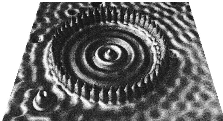
Abbildung 3.20: Topographische Oberflächenaufnahme (CCI-Modus) einer durch Nanopositionierung entstandenen Ringstruktur, bestehend aus 48 Fe-Atomen auf einer Cu(111)-Oberfläche. Der Ring mit einem Durchmesser von 142,6\text{\AA} umschließt eine stehende Oberflächenwelle, gebildet aus sp-ähnlichen Cu(111)-Oberflächenzuständen [79].
