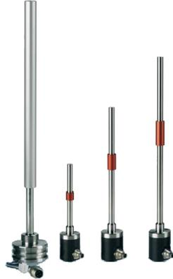
**Abbildung 5.1:** Induktionssensor mit langer Spule. Die Länge der Spule gibt den Messbereich vor. Um die Spule herum befindet sich ein Rohr aus Metal, das als zu erfassendes Objekt dient und verschoben werden kann. Die längste Version kann einen Abstand von 65 cm messen.[12]
