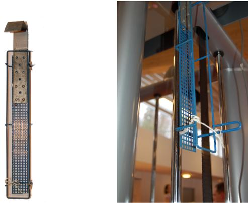
**Abbildung 6.12:** Befestigungsvorrichtung des IR-Abstandssensors. Alle hier erwähnten IR-Sensoren können in den unteren Teil des blauen Korbes gestellt werden, so dass die Messrichtung in Richtung Boden zeigt. Der obere Teil kann für verschiedene Geräterahmen per Hand zurecht gebogen werden. Oberer und unterer Teil lassen sich zur Abstandskorrektur durch Schrauben in der Höhe verstellen.
