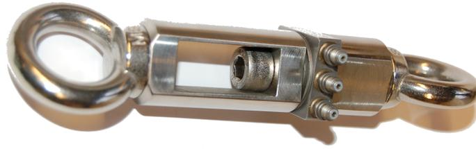
**Abbildung 6.5:** Kraftadapter mit eingebautem Kistlerelement. Durch Anziehen der zentralen Schraube wird eine Vorspannung erzeugt. Wird später durch Ziehen an den Ringschrauben der Vorspannung entgegengewirkt, wird es möglich Zugkräfte zu messen.
